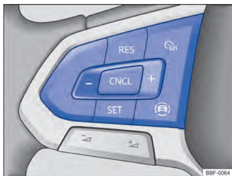
Fig. 101 Lado esquerdo do volante multifunções (variante 2): botões para comandar o limitador de velocidade.
