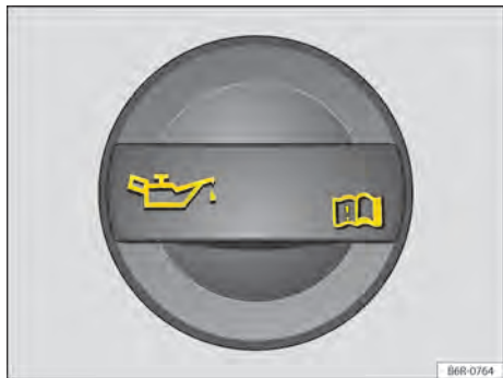
Fig. 166 No compartimento do motor: tampa da abertura para enchimento de óleo do motor.
