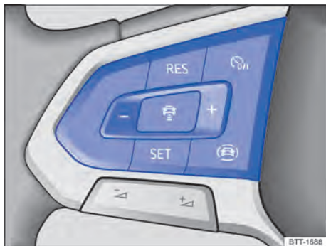
Fig. 105 Lado esquerdo do volante multifunções: botões para comandar o ACC.
