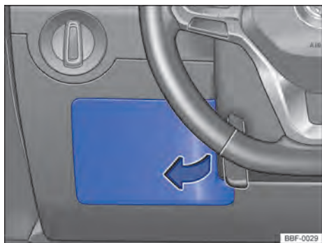
Fig. 150 No lado do condutor do painel de instrumentos: cobertura da caixa de fusíveis.
