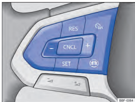
Fig. 99 Lado esquerdo do volante multifunções (variante 2): botões para comandar o GRA.
