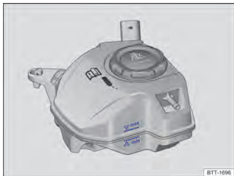
Fig. 167 No compartimento do motor: marcação no reservatório de expansão do líquido de arrefecimento do motor.
