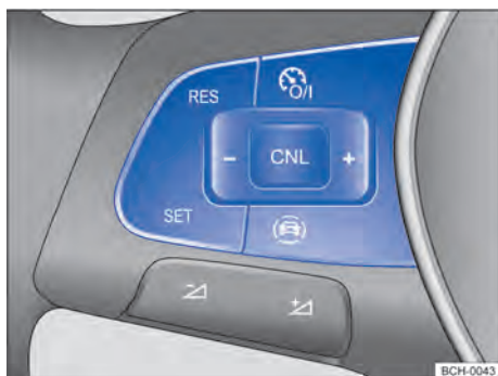
Fig. 98 Lado esquerdo do volante multifunções (volante 1): botões para comandar o GRA
