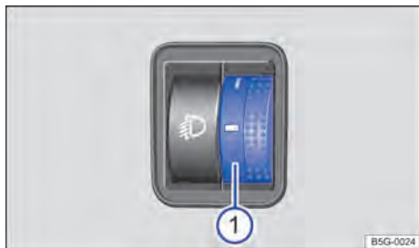
Fig. 72 Ao lado do volante: regulador do alcance do farol ① (variante 1).
