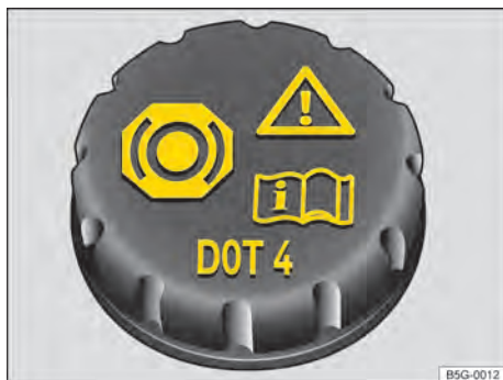
Fig. 169 No compartimento do motor: tampa do reservatório de fluido de freio.
