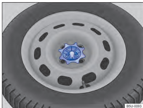
Fig. 176 No compartimento de bagagem: manípulo para fixação da roda de emergência.
