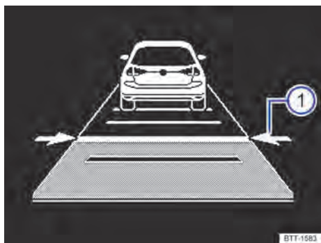
Fig. 106 No display do instrumento combinado: ajustar a distância (representação esquemática, o ACC regula).
