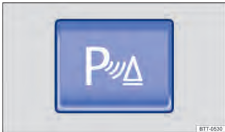
Fig. 110 No console central: botão para ligar e desligar o auxílio de estacionamento.
