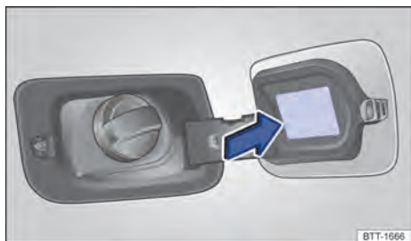
Fig. 174 Na parte interna da portinhola do tanque de combustível: etiqueta com a pressão dos pneus.
