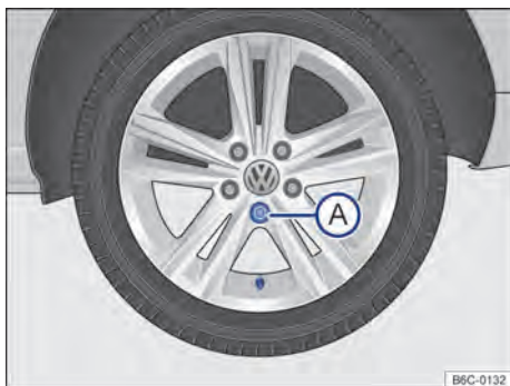
Fig. 178 Retirar a calota integral.
