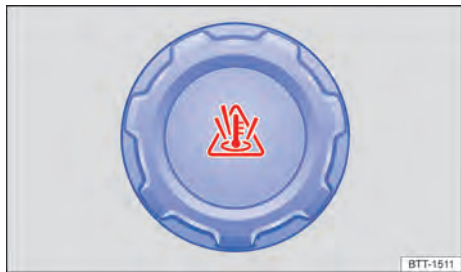
Fig. 168 No compartimento do motor: tampa do reservatório de expansão do líquido de arrefecimento do motor.
