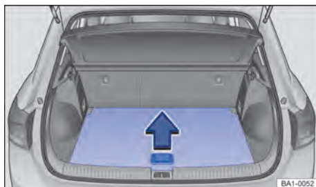
Fig. 139 No compartimento de bagagem: levantar o assoalho do compartimento de bagagem.
