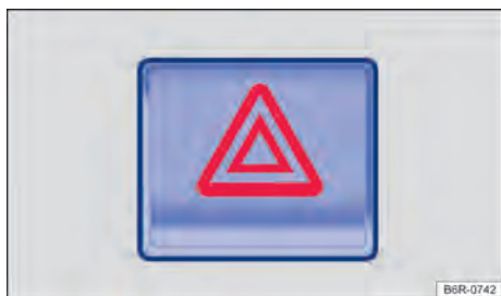
Fig. 45 Na parte superior do console central: interruptor das luzes de advertência.
