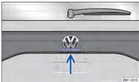
Fig. 58 Na tampa traseira: botão para abrir a tampa traseira.
