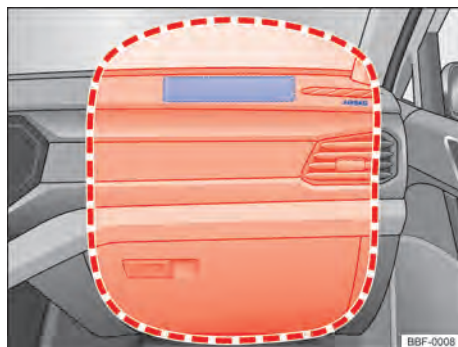
Fig. 34 Local de instalação e área de expansão do airbag frontal do passageiro dianteiro.
