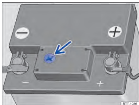
Fig. 170 No compartimento do motor: exemplo de posição do visor no lado superior da bateria do veículo.
