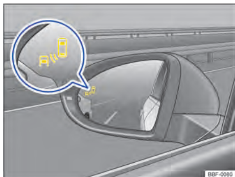
Fig. 108 Nos espelhos retrovisores externos: indicador do sensor de ponto cego.
