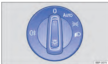
Fig. 70 Ao lado do volante: interruptor de luzes (uma variante).
