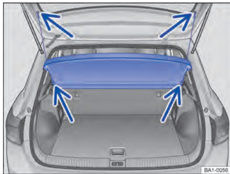
Fig. 138 No compartimento de bagagem: remover e instalar a cobertura do compartimento de bagagem.
