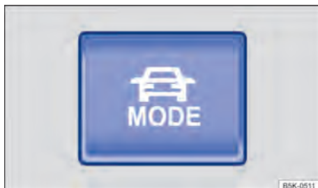
Fig. 95 Na parte superior do console central: botão MODE de seleção do perfil de condução.
