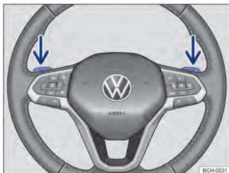
Fig. 93 Volante com seletores basculantes do Tiptronic.
