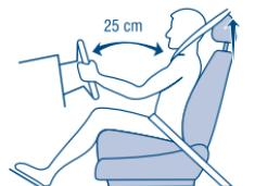
Não permita que o passageiro viaje no banco dianteiro com os pés, joelhos ou qualquer outra parte do corpo em contato ou demasiadamente perto da tampa do air bag. Há risco de sérios ferimentos se houver disparo do air bag.
