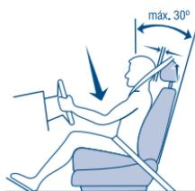
Deve-se manter uma distância mínima de 25 cm entre o volante e o peito do motorista para reduzir o perigo de ferimento por proximidade excessiva do air bag quando este é inflado. O mesmo se aplica para o passageiro da frente.
