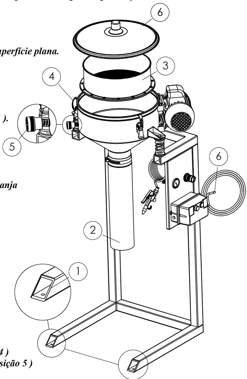
**2. Uma vez posicionado, fixe-o ao solo utilizando a furação de fixação ( posição 1 ).**
